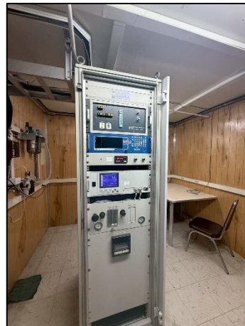
รูปที่ 2-3 ระบบตรวจสอบคุณภาพอากาศแบบต่อเนื่อง (CEMs)
